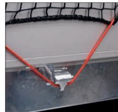
An den HB- und HM-Basismodellen sind rundherum speziell entwickelte Scharnierhaken angebracht. Das Ladungsnetz lässt sich mit dem Haken problemlos befestigen.
