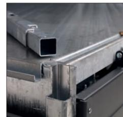
Sowohl die HB- als auch die HM-Modelle verfügen über eloxierte Aluminiumbordwände und vier herausnehmbare Eckrungen. Der Cobalt+ ist serienmäßig mit pulverbeschichteten Aluminiumbordwänden, 40 cm hoch (anthrazitgrau) ausgestattet.
