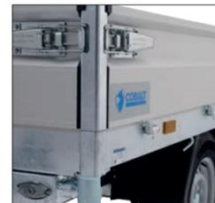
Intelligent konzipierte (Eck-)Rungenkonstruktion mit HAPERT-Verriegelung: eine robuste und einfach bedienbare Zieh-Schub-Verriegelung, die in die (Seiten-)Wände aus Aluminium integriert ist, um flache Wände zu gewährleisten.
