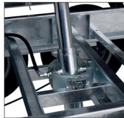
Alle HAPERT-Kipper nutzen einen leistungsstarken Hydraulikzylinder und sind je nach Abmessungen in 3-, 4- oder 5-stufiger Ausführung erhältlich.
