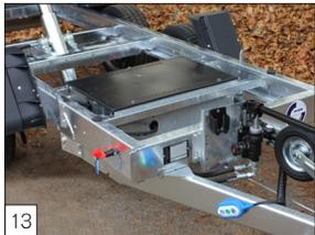
**Option:** elektrische Bedienung inkl. Batterie in Stahl-kasten mit Deckel.
