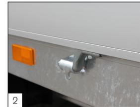
**Serienausstattung:** ingenieüser Entwurf der HAPERT-Scharniere für eine äußerst praktische Befestigung z.B. des Ladungsnetzes.
