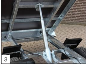
**Serienausstattung:** ausgestattet mit einem 3- Stufigen, soliden Hydraulikzylinder, Kippwinkel nicht weniger als 60°!
