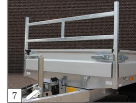
**Option:** abnehmbares Frontgitter montiert.
