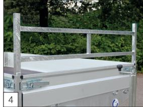
**Option:** Abnehmbares Frontgitter montiert und gesichert in den Ecken.
