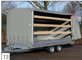
**Option:** Links und rechts eine Schiebeplane montiert (ab 450 cm inkl. Mittelpfosten).
